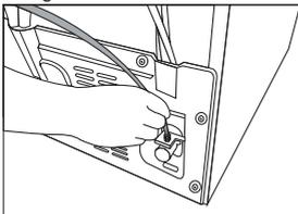
2. Schließen Sie das andere Ende des Wasserschlauchs an der Wasserpumpe an, indem Sie den Schlauch in den Schlauchanschluss der Pumpe schieben.
