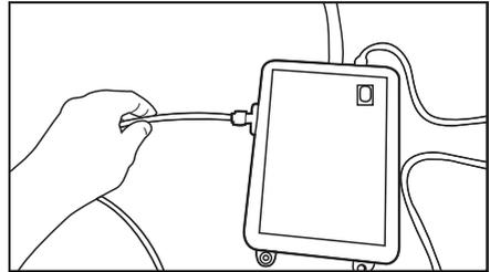
5. Um zu vermeiden, dass der Wasserschlauch beschädigt wird, sich verschiebt oder aus Versehen sich löst, befestigen Sie die Klammern an die geeigneten Plätze.
