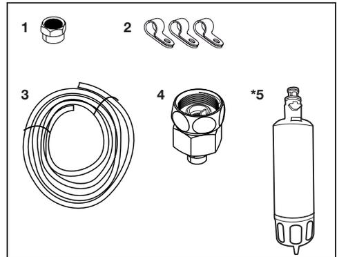
1. Anschlussmuffe (1 Stück): Wird zum Verbinden des Wasserschlauchs am Rückteil des Geräts verwendet.
