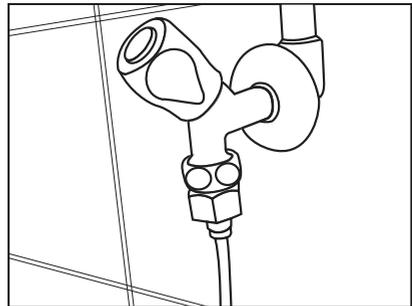
3. Stecken Sie die Anschlussmuffe auf den Wasserschlauch.
