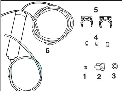
1. Anschlussmuffe (1 Stück): Wird zum Verbinden des Wasserschlauchs am Rückteil des Geräts verwendet.
