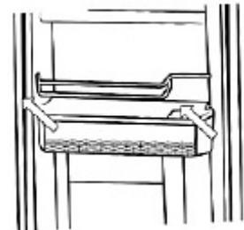
Schieben Sie einen Flachsraubenzieher behutsam zwischen die Kante(n) des Wasserventils und des Formteils des Wasserspenders. Dann heben Sie die Kanten langsam und vorsichtig an beiden Seiten des Wasserventils mit dem Schraubenzieher an; das Wasserventil sollte sich heben und von Hand in einem 45° Winkel entfernt werden.
