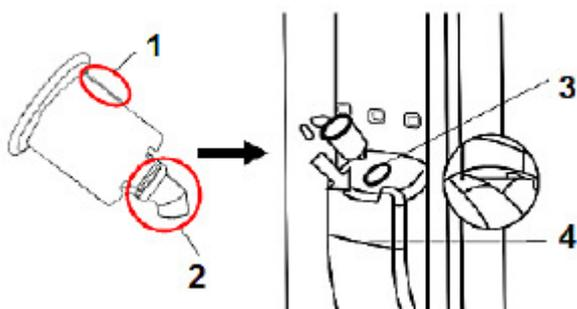
1 Nut 2 Stutzen 3 Formteilöffnung 4 Formteil
