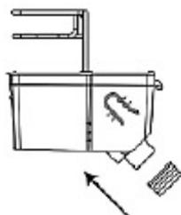
dass dabei keine Falten und Knicke entstehen. Bringen Sie den Wassertank wieder in der Tür an. Achten Sie beim Einbau darauf, dass der Dichtungsring vorher in das Wasserventil eingebracht wurde. Halten Sie dann beide Seiten des Wassertanks gut fest, richten Sie die Steckplätze am Wassertank an denen in der Tür aus und bringen Sie den Wassertank in einem 45° Winkel an.
